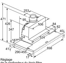
Réglage de la profondeur du tiroir-filtre possible jusqu'à 29 mm Mesures en mm
